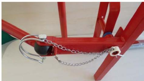
Bügelverschluß und Splint bitte wie auf der Abbildung befestigen.
